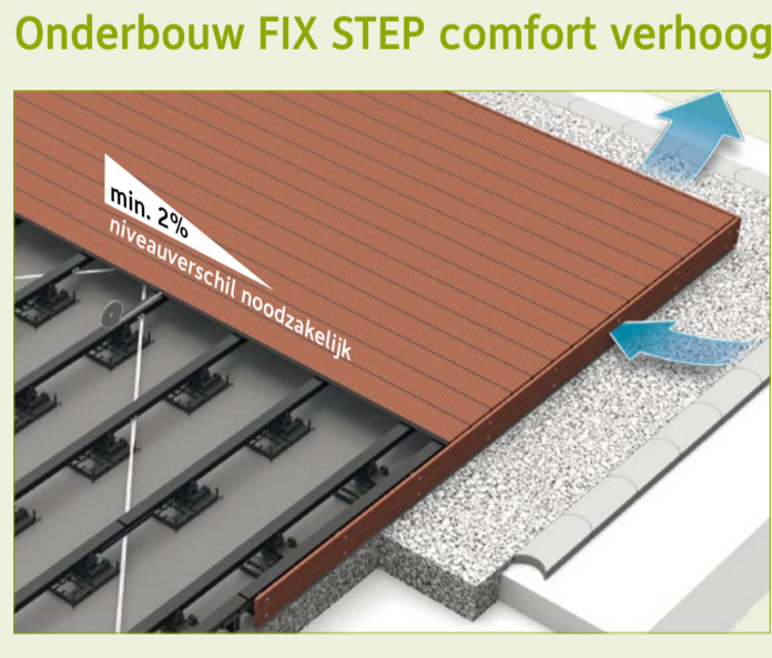
Gesloten voeg met groeflijst/voegprofiel P5 - uitsluitend met verhoogde opbouw mogelijk door middel van comfortpad en opzetstuk.
