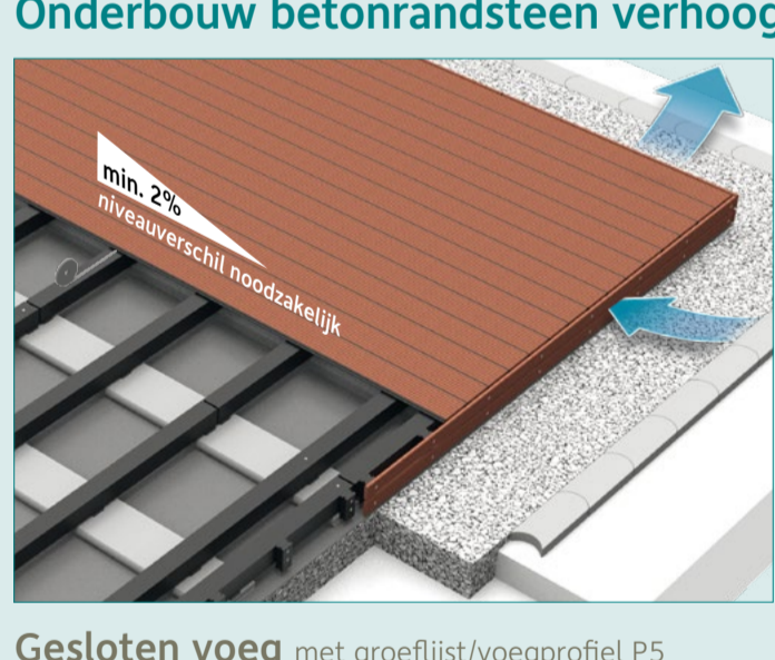
Gesloten voeg met groeflijst/voegprofiel P5 - uitsluitend met verhoogde opbouw mogelijk door middel van 90 x 90 mm comfortpad en opzetstuk.
