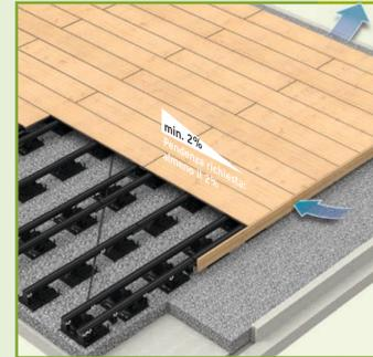
Giunto chiuso con profilo per giunti P5\* - possibile solo per costruzioni rialzate a partire da 166 mm di altezza (terza fase STEP) mediante elemento comfort e elemento di rialzo
