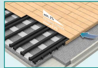
Giunto chiuso con profilo per giunti P5 - È possibile solo con una struttura rialzata utilizzando delle traverse da 90 x 90 mm
