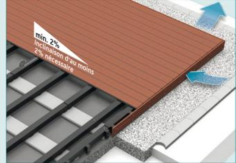
Joint fermé avec baguette rainurée/joint profilé P5
