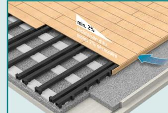
Joint fermé avec joint profilé P5
