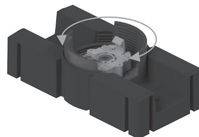
**3** Ajustez le disque manuellement ou avec une clé Allen (10mm) dans l'hexagone.
