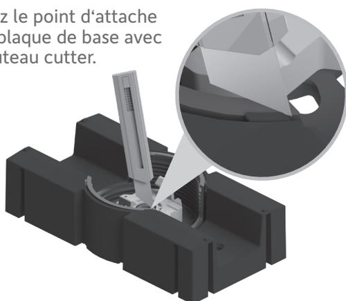
**2** Tournez toujours d'abord l'anneau extérieur pour atteindre la hauteur de montage souhaitée. Pour un ajustement fin et pour les hauteurs plus élevées, utilisez le disque.
