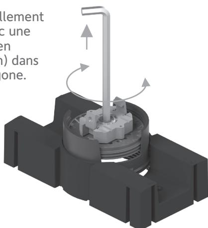
**4** Réglage fin avec lambourde engagée : Tournez le disque manuellement ou à l'aide d'un tournevis. Pour ce faire, insérez le tournevis par le haut dans une ouverture sur le côté du disque et faites le tourner par une action de levier.
