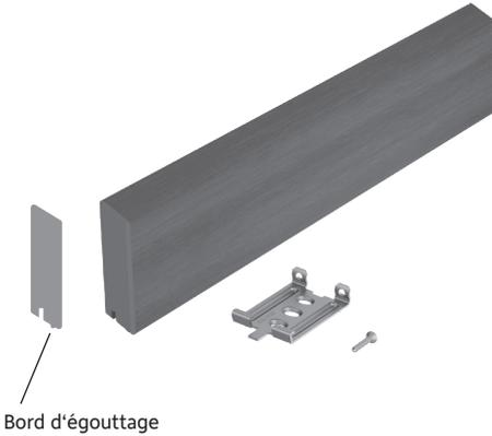
Les vis de fixation doivent être adaptées à la sous-construction. L'aboutage frontal doit être d'au moins 8 mm.
