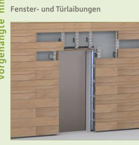
**L-PROFIL** verwendbar als Startprofil, Umfassungprofil, Brandsperre, Systemtrennung und Kleintierschutz
