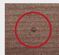
naturalne wtrącenie włókien przed usunięciem
