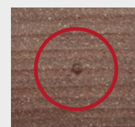
naturalne wtrącenie włókien przed usunięciem
